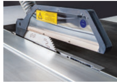
Testere Ünitesinin Otomatik Yükseklik Ayarı Automatic Height Adjustment of Saw Unit
