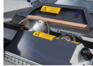
Testere Ünitesinin Otomatik Açı Ayarı Automatic Tilt Adjustment of Saw Unit
