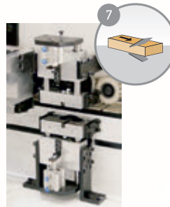
Tutkal Kazıma Ünitesi (Düz Kazıma) Glue Scraper Unit (Flat Scraper)
