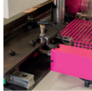
EKS Otomatik Ön Siper Ayarı Ön Frezenin yapacağı temizlik miktarını belirler. Automatic Fence Adjustment with ECS Adjusts the premilling distance from the edge.
