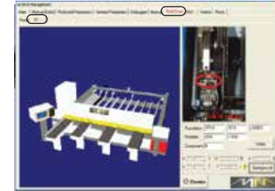
3 Boyutlu uyarı sistemi makinedeki arızaları gösterir.
