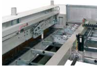
Güçlü Servo Motor ile Yüksek Hızda Pozisyonlama
