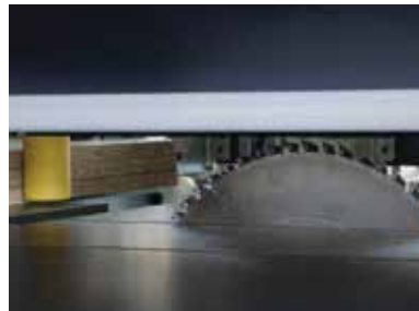
Kesilen parça yüksekliğine göre otomatik ayarlanan testere hızı
