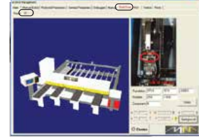
3 Boyutlu uyarı sistemi makinedeki arızaları gösterir.
